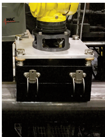
Transdutor com mola e sapata inspecionando o cordão de solda do tubo.
