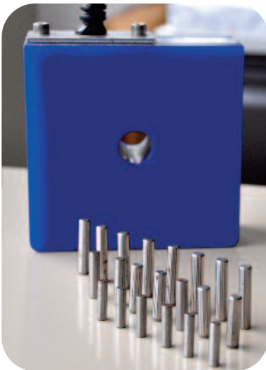
Bobina de teste típica e pinos com comprimentos de 3/4", 1" e 1 1/4" utilizados para gerar os sinais de teste mostrados na tela superior direita.
