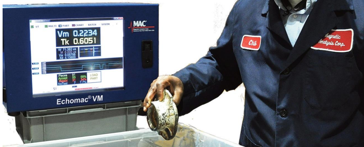
Tela A-scan mostrando os resultados do ensaio de uma peça
