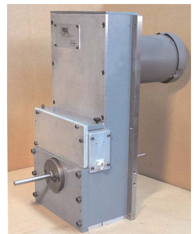
O Rotomac® pode ainda ser instalado em linha com uma operação contínua de arame, tal como uma trefilação, extrusão ou endireitamento e corte, com marcação e separação automática de peças defeituosas.
